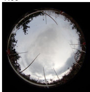
図 3. 開空度測定用に撮影した写真(10 月 30 日)。(1)(3)が、魚眼レンズで撮影した画像(分かりづらいけどカラー画像)。これを白黒画像(2)(4)に直して開空度を計算した。
